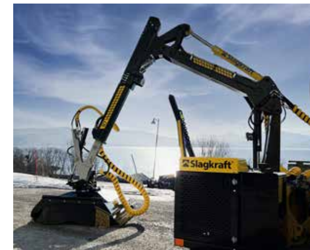
SC7 • En moderne kran med høy kranstøyle, kortere løftearm og beskyttet konstruksjon. For rydding av mindre veier.
