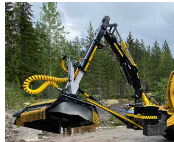
SC45 • En liten och smidig kran med en räckvidd upp till 6,3 meter med en SH150-släga.
